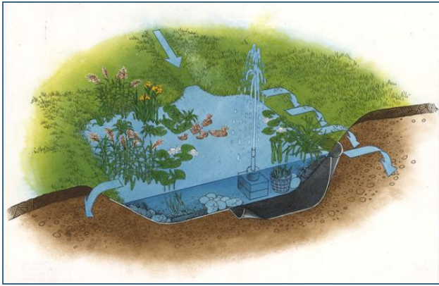
Abb. 6: Abfließendes Wasser kann auch in einen Sickerteich geleitet werden. Im Beispiel versickert das Wasser nicht am Grund, sondern an den oberen Rändern des Teichs. Der Sickerteich kombiniert Versickerung und Rückhaltung.
