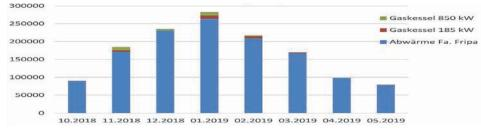
In der Heizperiode 2018/2019 konnten über 95 Prozent des Wärmebedarfs des Schulzentrums Miltenberg durch die Abwärme der Fripa gedeckt werden.
